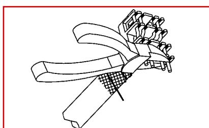
Odstraňte přebytečnou délku vodičů jednotlivých páru na konci kabelové matice. Použijte kleště s úhlovým bočním stříkem (HTOOL00002).
