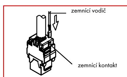
V případě potřeby uzemněte modul pomocí Fast-on kontaktu a přivedeného vodiče
