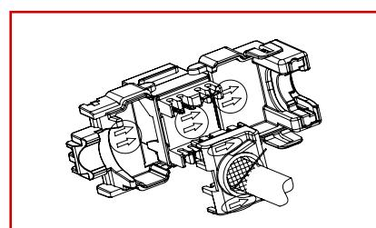
Připravte si kabelovou matici a modul tak, aby šípky na obou částech měly stejnou orientaci.
