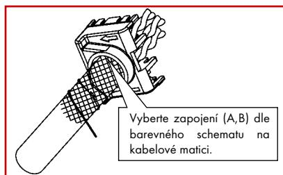
Kabel protáhněte skrz kabelovou matici tak, aby vodič drážky pro jednotlivé vodiče směrovaly od samotného kabelu.
