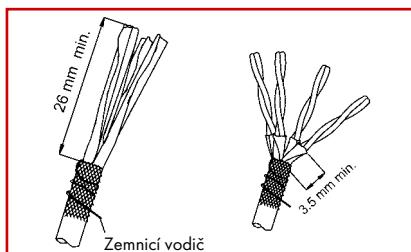
Odstraňte vnější plášť kabelu v délce min. 26 mm od konce kabelu. Opletení přetáhněte zpět přes vnější plášť kabelu. Zemnící vodič omotajte kolem vnějšího pláště a případně zafixujte vodivou páskou. Zachovávejte individuální fólie každého páru v délce 3,5 mm.
