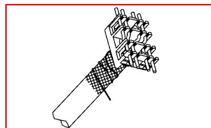
Vložte jednotlivé vodiče do příslušných drážek. Max. průměr vodiče je AWG 26 až AWG 22. Do drážek vstupují samostatné páry bez stínění a ostatních ochranných prvků.
