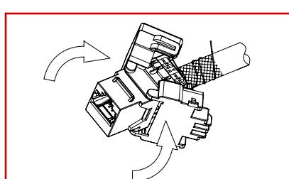
Samotné napojení kabelové matice na modul RJ45 zajišťují postranní kryty, které přitlačte a zacvakněte směrem ke středu modulu.
